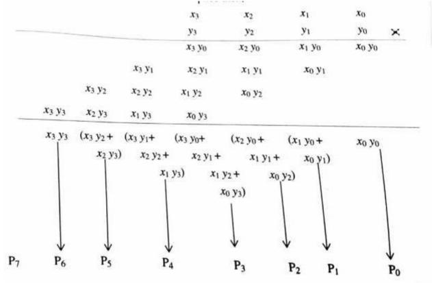
Product bits  $\rightarrow$  (P<sub>7</sub> P<sub>6</sub> P<sub>5</sub> P<sub>4</sub> P<sub>3</sub> P<sub>2</sub> P<sub>1</sub> P<sub>0</sub>)
